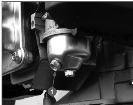
Рис. 16 Слив топлива из карбюратора
