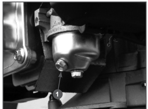
Рис. 19 Слив топлива из карбюратора
