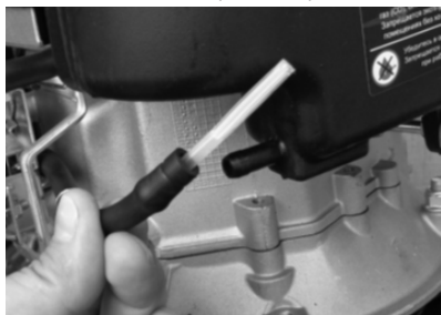
Рис. 17 Обслуживание топливного фильтра
