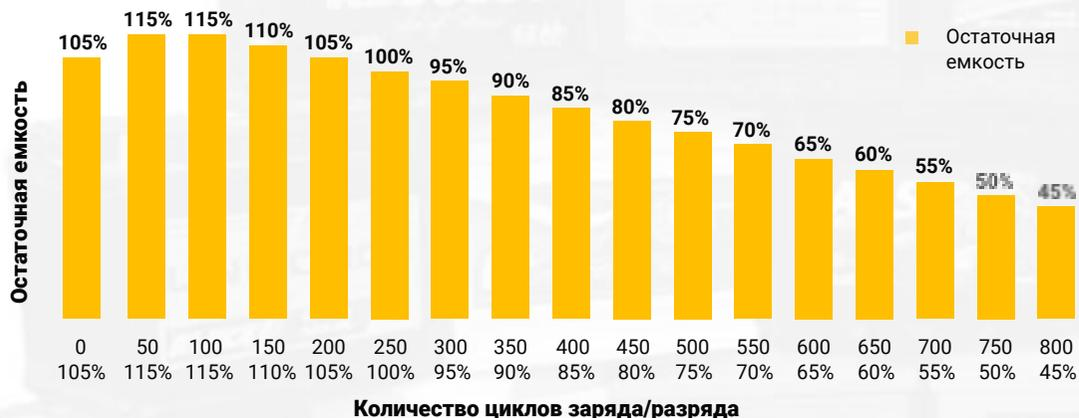
Зависимость количества циклов от глубины разряда по C5 при +25
