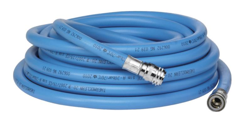
Предназначен для подачи воды для уборки. Температура воды не должна превышать 70°С. Готов к использованию. Оба конца шланга оснащены муфтами 1/2". Комплектуется ниппелями с шагом резьбы 1/2 ", 3/4" и М22х1 для подключения к системе водоснабжения.
